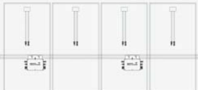
Abb.1 Installationseinbaulage des Mikrowechselrichters
