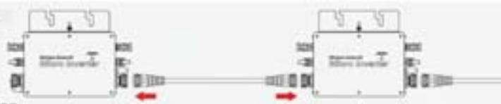
B) Bringen Sie die AC-Endkappe am offenen AC-Anschluss des an letzter Mikro-Wechselrichter in der AC-Zweigschaltung.
